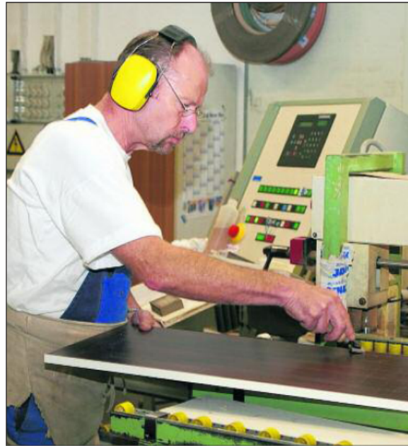
Jürgen Fritsche arbeitet bei Ratiomat an einer Maschine, mit der die Kanten der Küchentüren und -klappen beschichtet werden. –FOTO: CLAUDIA DOHLE
